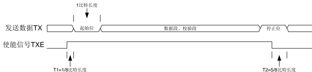
图 13-3 输出使能信号 TXE 时序图
